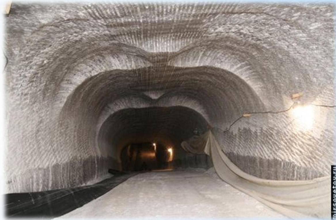
**Шахтеры выпиливают блоки, которые потом разбивают на куски, грузят в вагонетки и на специальных поездах вывозят наверх.**
